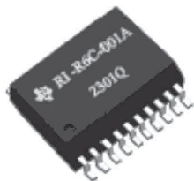
Рис. 5. Унифицированная микросхема считывателя RI-R6C-001A.
